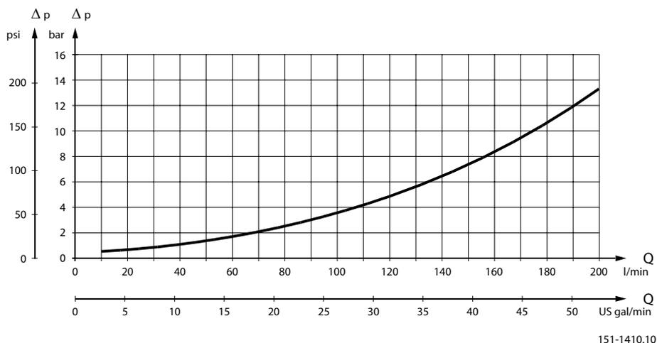
上記の曲線は、無負荷で粘度  $35\text{mm}^2/\text{s}$  [165 SUS] の作動油の時の値です。
