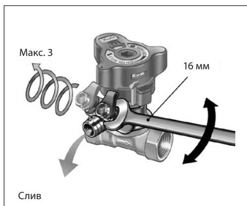
Для удобства работы блок с дренажным краном можно поворачивать на 360°.
