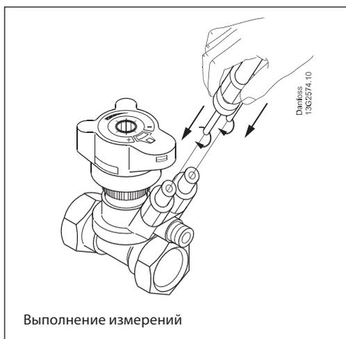
Расход через клапан Leno™ MVT можно проверить с помощью измерительных приборов Danfoss PFM 5001 или других производителей.
