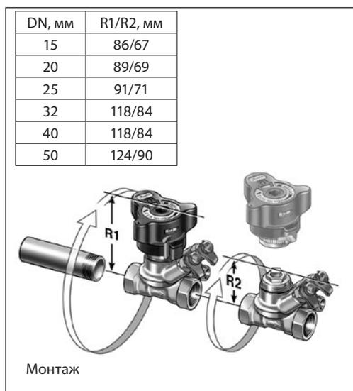
Перед установкой клапана трубопроводы системы должны быть промыты.
