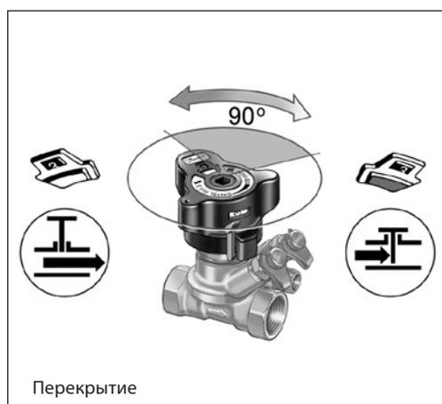
Перед перекрытием клапана его настройка должна быть заблокирована — для этого нужно нажать на рукоятку.
