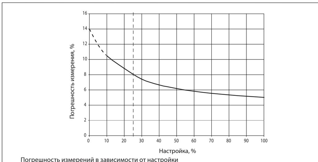
Клапан Leno™ MVT является точным из-за разделения функций настройки и перекрытия потока.
