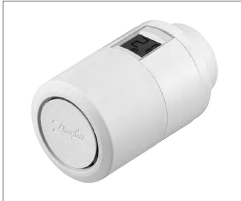
Danfoss Eco™ представляет собой автономный программируемый термостатический элемент для бытового использования. Питание Danfoss Eco™ от двух батарей типа AA 1,5 В, термостатический элемент имеет компактный корпус и легок в управлении с помощью поворотной рукоятки и одной кнопки. Danfoss Eco™ программируется с помощью приложения на смартфоне по протоколу Bluetooth.
