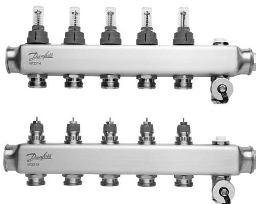
Der SSM-Verteiler wird zur Durchflussregelung in Fußbodenheizungen eingesetzt. Die einzelnen Heizkreise des Fußbodenheizungssystems werden an den Verteiler angeschlossen. Dadurch können Durchfluss und Wärmeabgabe für einzelne Räume eines Gebäudes individuell gesteuert werden.
