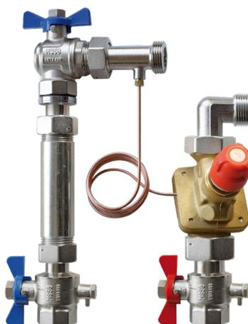
Das AB-PM-Anschlussset ist eine kompakte und zeitsparende Lösung. Es wurde für einen optimalen hydraulischen Abgleich in Fußbodenheizungen konzipiert. Eine differenzdruckunabhängige Durchflussbegrenzung wird so gewährleistet.
