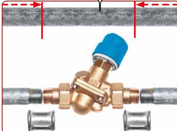
Следует отрезать участок длиной, как показано на рисунке (клапан с надетыми на него фитингами). Также необходимо предусмотреть небольшой зазор для резьбы на концах трубопроводов стояка, которые будут вкручены в бочонки.
