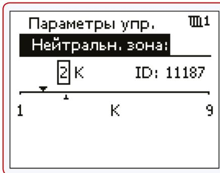
Если изменение температуры подаваемого теплоносителя допустимо в широком диапазоне, то нейтральную зону следует установить на высокое значение. Если фактическая температура теплоносителя лежит в нейтральной зоне, то регулятор не будет приводить клапан в действие.
