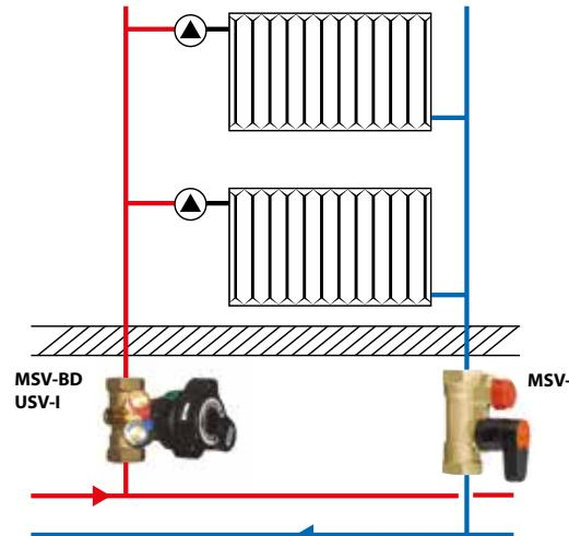
В качестве балансировочного клапана используется клапан MSV-BD (либо USV-I), который может быть установлен на подающем либо на обратном стояке. На **другой** стояк устанавливается либо запорный вентиль MSV-S, либо шаровой кран.
