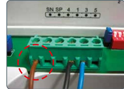
2.5.6. Клеммы 1 и 3 — фаза при импульсном управлении приводом.
