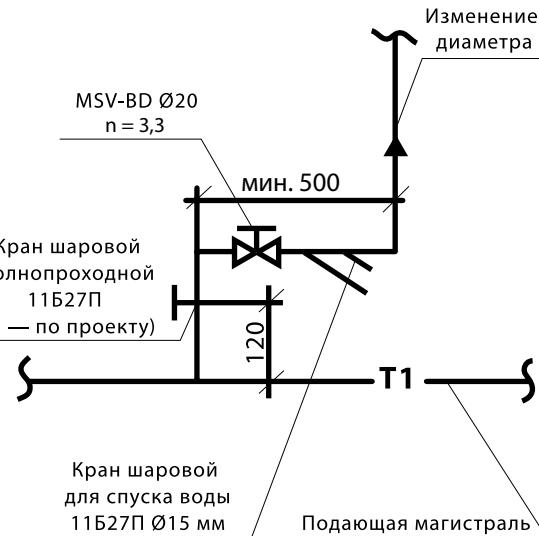
Настройка имеет цифровую шкалу с точностью 0,1 оборота.
