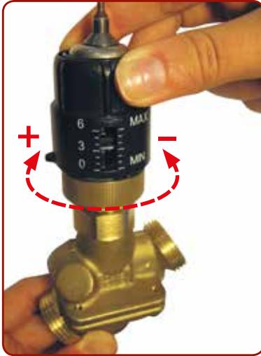
Термостат QT настраивается на требуемую температуру вручную поворотом рукоятки. Если требуется максимальные либо минимальные настройки, после выполненной процедуры рекомендуется на четверть повернуть настроечную рукоятку в сторону противоположной настройке. Это обеспечит наилучшую работу термоэлемента.
