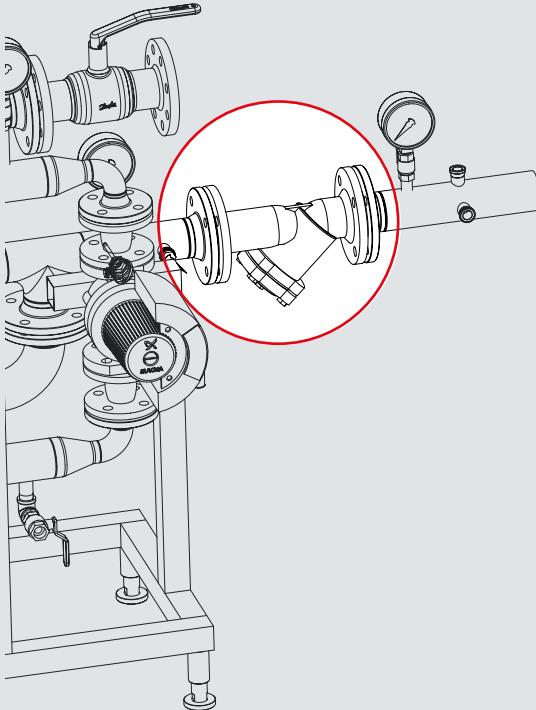
ФИЛЬТР ДОЛЖЕН БЫТЬ СМОНТИРОВАН НА ПОДАЮЩЕМ ТРУБОПРОВОДЕ ПЕРЕД СИСТЕМОЙ АУУ.
