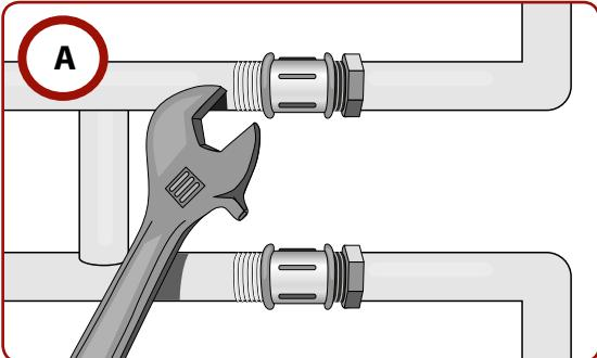
Присоединить к отводам со стороны стояка отопительный прибор с помощью муфт и контргаек. Муфты и контргайки установить на лен и пасту сантехническую.
