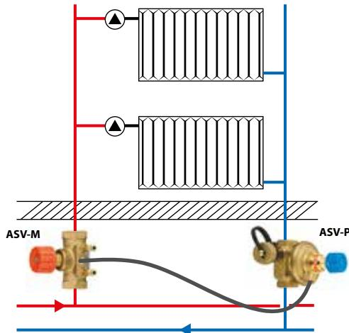
На подающем трубопроводе устанавливается клапан-партнер **ASV-M**. На обратном трубопроводе устанавливается балансировочный клапан **ASV-PV**, который необходимо настроить в соответствии с проектом. Между собой эти два клапана **ОБЯЗАТЕЛЬНО** должны быть соединены импульсной трубкой.
