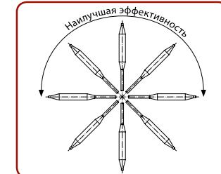
Установить термоэлемент QT на клапан AB-QM вручную, без использования инструментов. Максимальный крутящий момент не должен превышать 5 Н·м.
