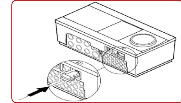
После включения регулятора на дисплей выводятся имя и версия ключа.
