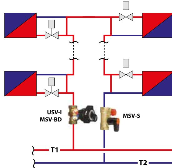
В качестве ручного клапана может применяться клапан USV-I либо MSV-BD, в качестве автоматического — только AB-QM. Балансировочный клапан должен устанавливаться в месте, указанном в проекте. Соответственно в противоположной части стояка устанавливается шаровой кран либо запорный вентиль MSV-S.
