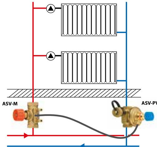
На обратном трубопроводе устанавливается регулятор ASV-PV (либо ASV-P), на подающем трубопроводе — клапан ASV-M (либо ASV-I, либо ASV-BD), и между собой они **обязательно** соединяются импульсной трубкой.
