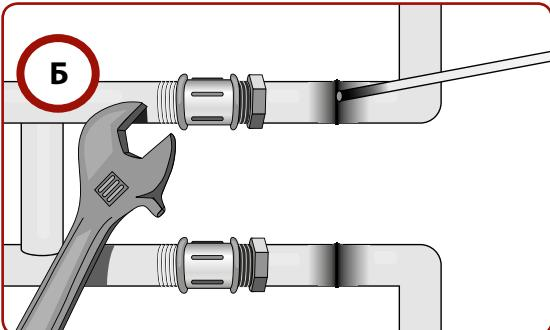
Приварить на концы отводов со стороны стояка патрубки с резьбовыми концами. Присоединить к отводам со стороны стояка отопительный прибор с помощью муфт и контргаек. Муфты и контргайки установить на лен и пасту сантехническую.
