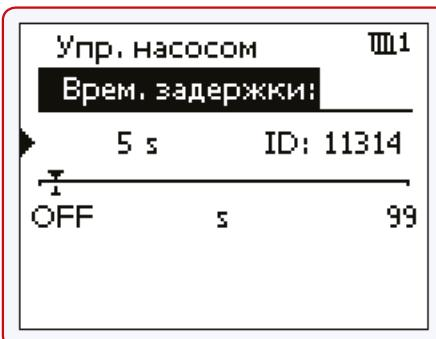
OFF («Выкл.»), то переключение с насоса на насос не произойдет. Это значение предназначено для настройки контроллера для управления системами с одним циркуляционным насосом. Заводская установка 5 с.
