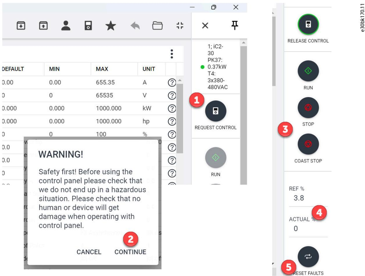
Figura 26: Azionamento del convertitore di frequenza tramite MyDrive® Insight
