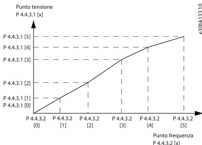
Figura 70: Esempio della caratteristica U/f
