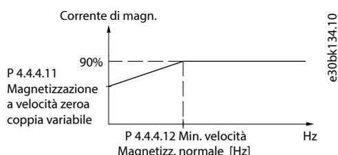
Figura 71: Magnetizzazione del motore
