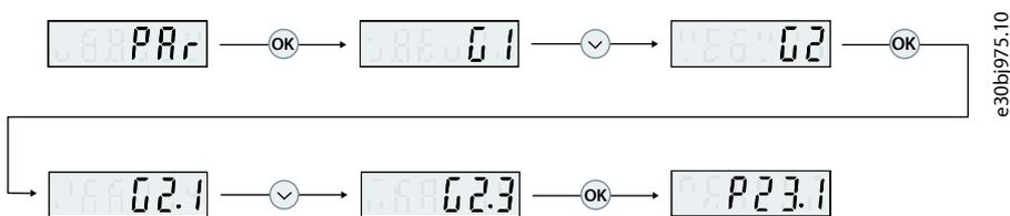
Figura 6: Esplorazione dei parametri
