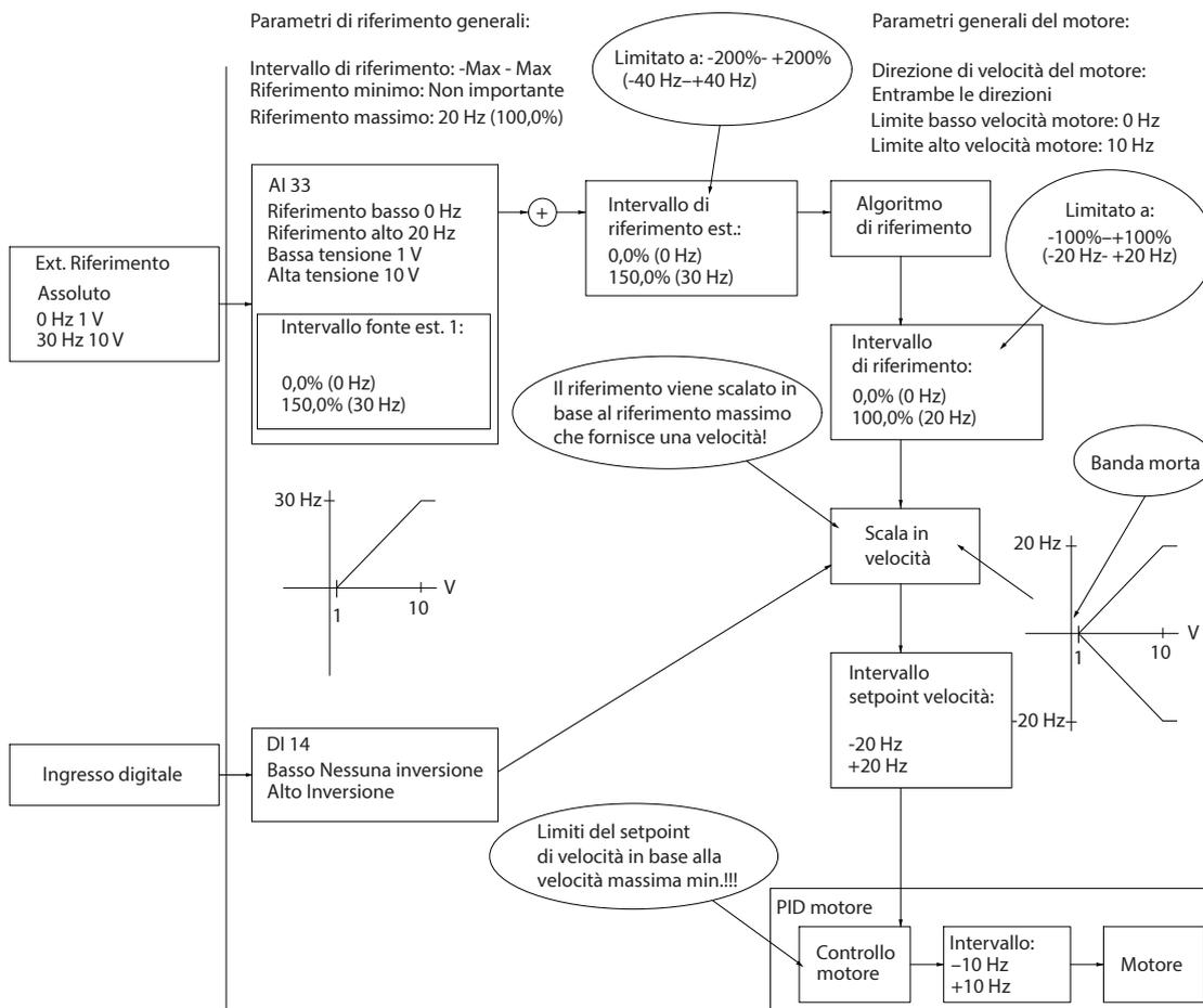
Figura 50: Blocco dell'ingresso di riferimento con limiti al di fuori di -massimo - +massimo
