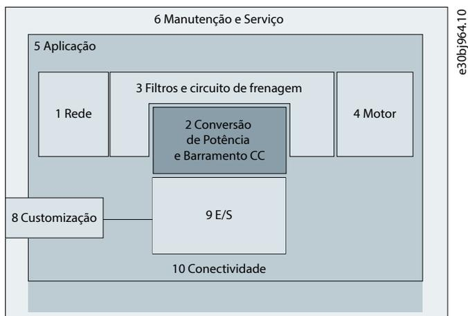
Figura 33: Visão Geral do Menu da Aplicação
