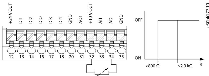
Figura 74: Conexão do Termistor PTC - Entrada Analógica
