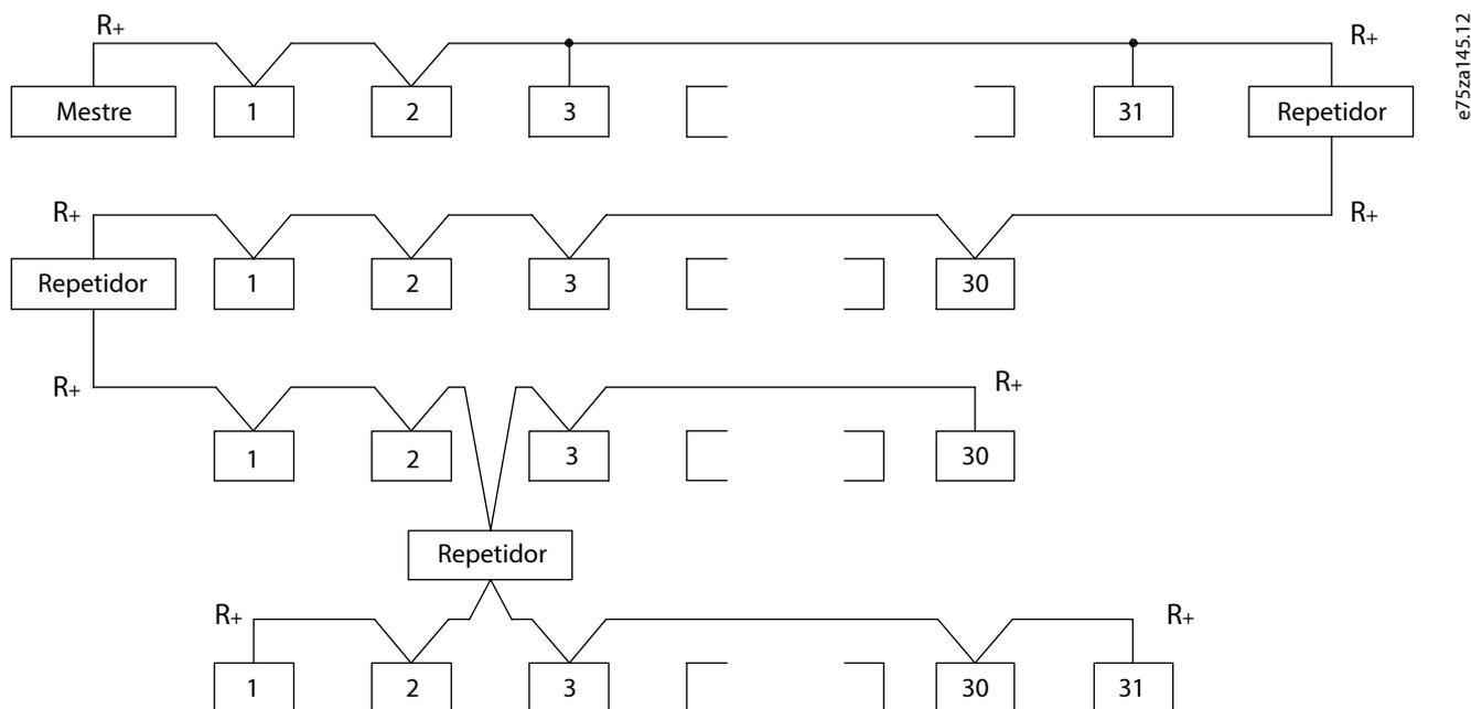
Figura 51: Interface de barramento RS485
