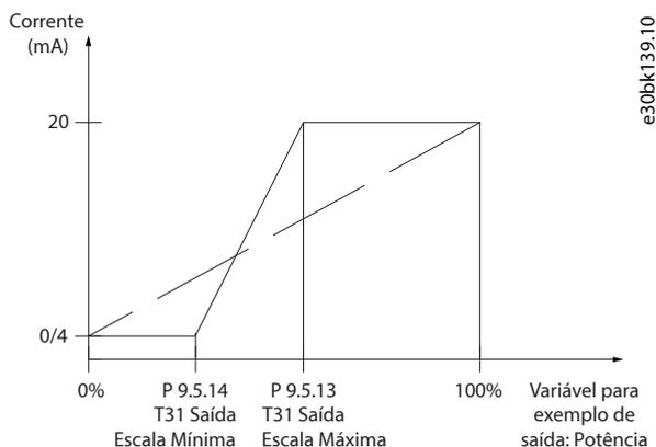
Figura 85: Escala de saída x Corrente
