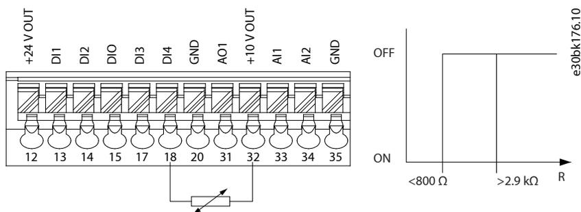
Figura 73: Conexão do Termistor PTC - Entrada Digital
