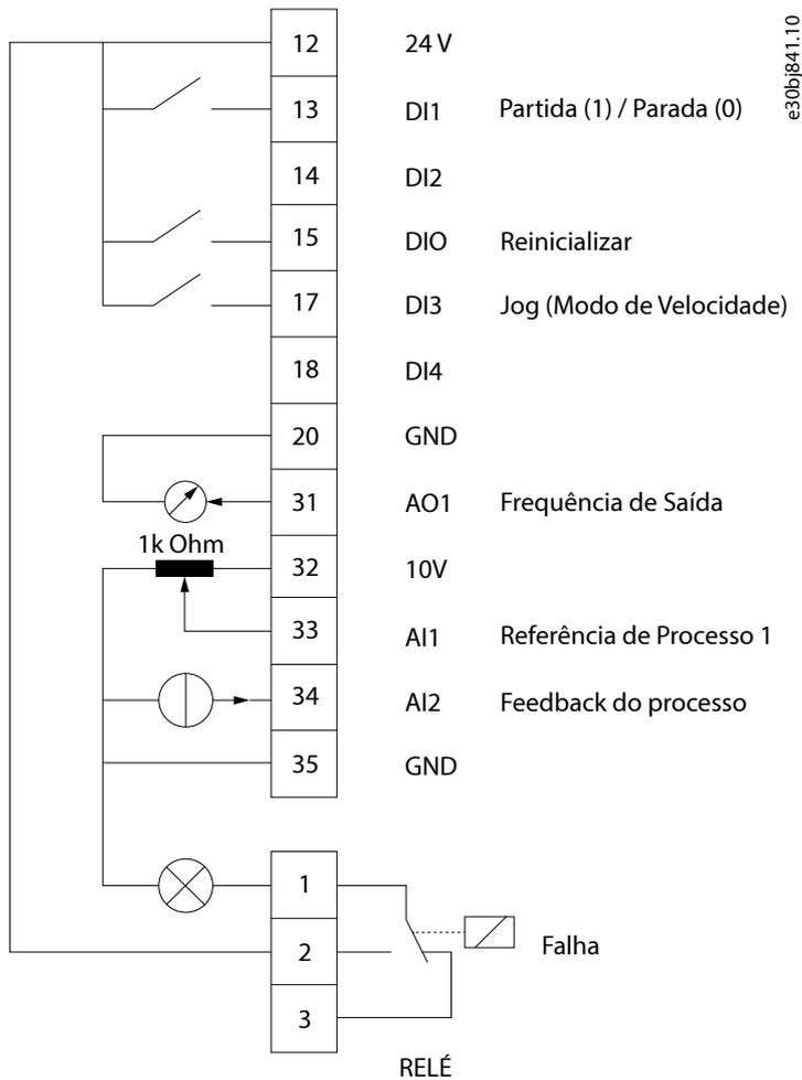
Figura 38: Conexões padrão para controle de processo
