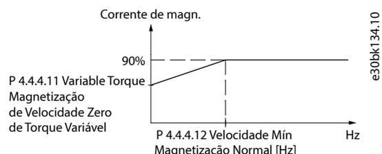
Figura 71: Magnetização do motor
