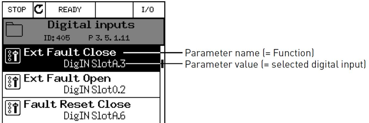
Figure 5. Digital input selection parameter
