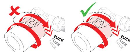
3. Appuyez sur le bouton et maintenez-le enfoncé 3 secondes. La tête électronique Danfoss Zig-bee OEM est installée et affiche la température actuelle.
