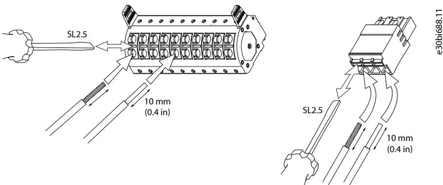
Abbildung 92: Einsetzen der Drähte in den Steckverbinder
