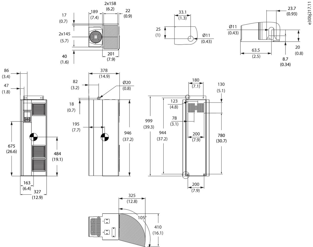
Abbildung 43: Abmessungen FB09a
