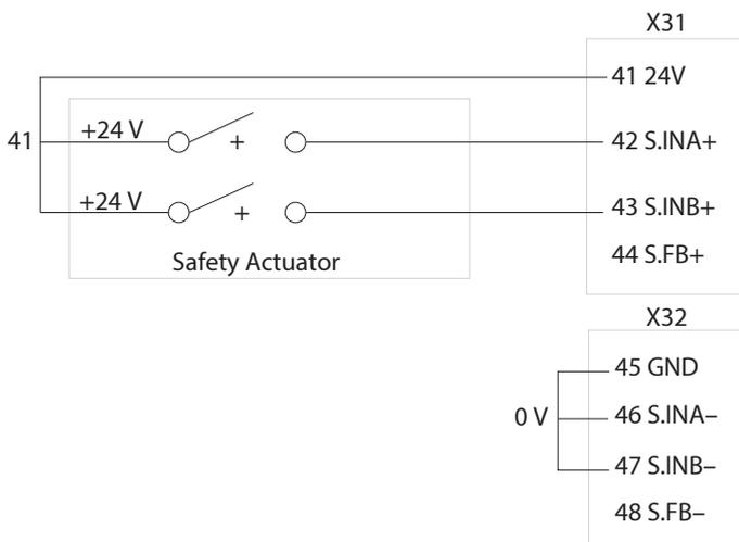
Abbildung 94: STO-Anschlussbeispiel für die Verwendung der gleichen Polaritäten (Kanal A und Kanal B = 24 V)
