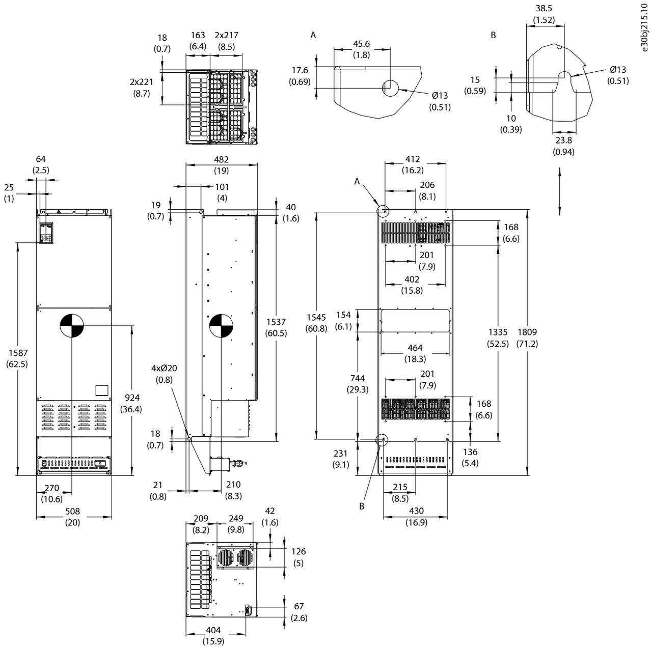
Abbildung 27: Außenabmessungen FA11
