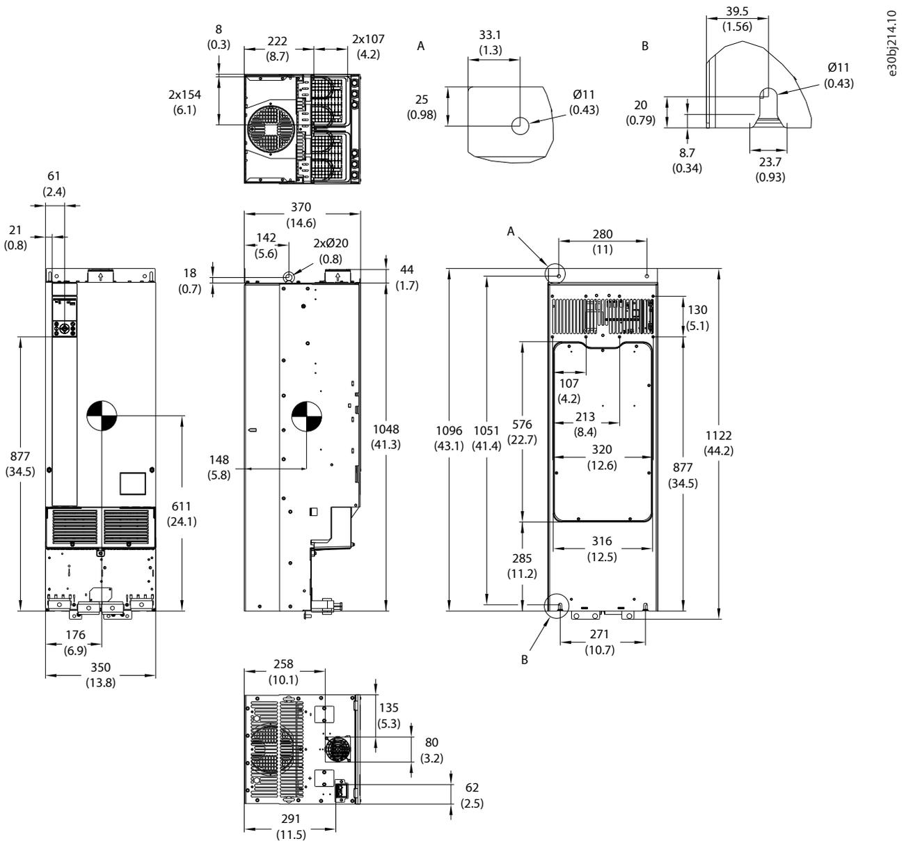
Abbildung 25: Außenabmessungen FA10
