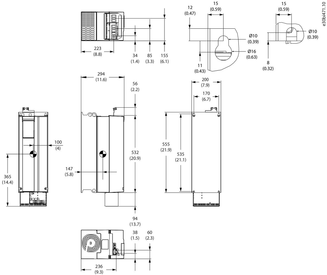
Abbildung 20: Abmessungen FA06
