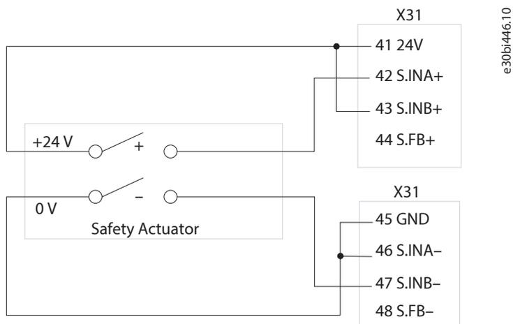
Abbildung 95: STO-Anschlussbeispiel für die Verwendung unterschiedlicher Polaritäten
