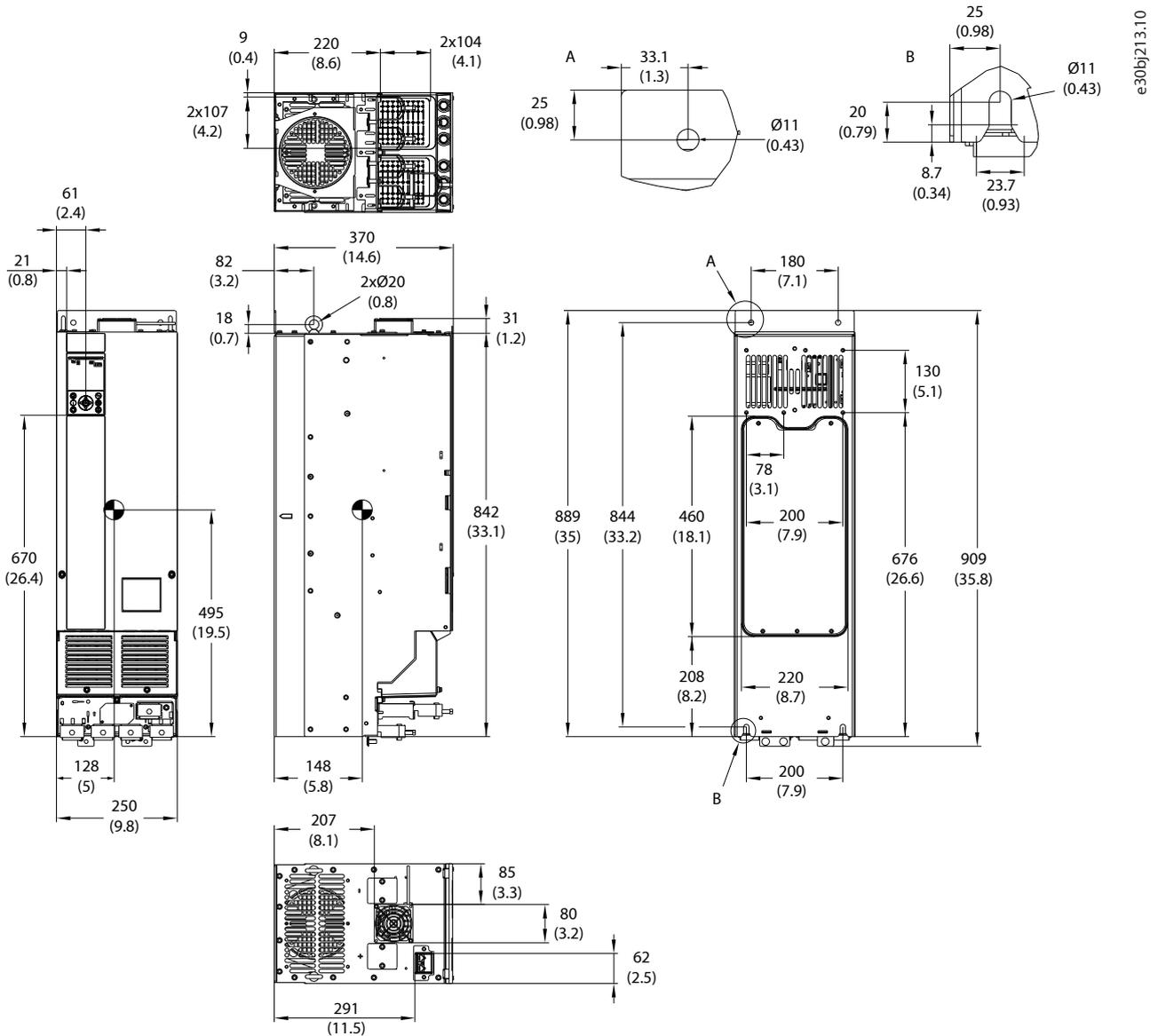
Abbildung 23: Außenabmessungen FA09
