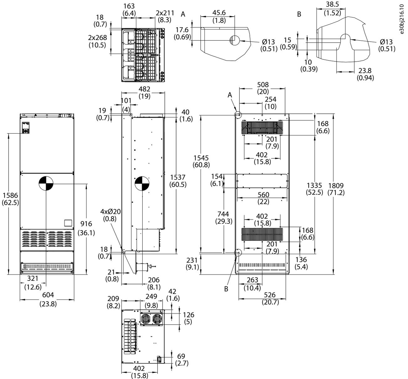
Abbildung 29: Außenabmessungen FA12
