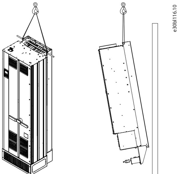
Abbildung 75: Anheben der Baugrößen Fx11–Fx12 mit einer Hebestange
