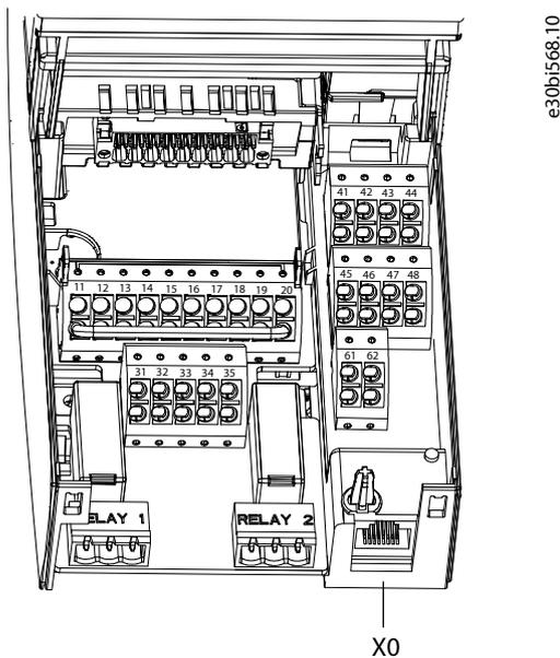
Abbildung 86: Position des X0-Anschlusses auf der Steuerkarte
