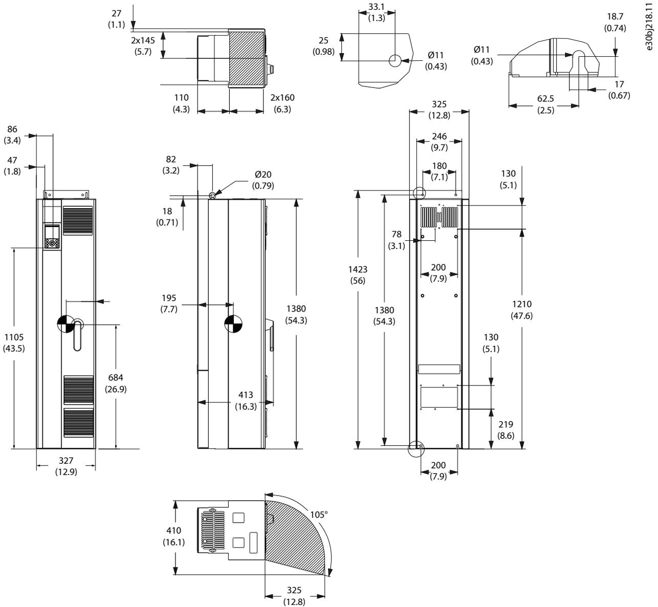
Abbildung 45: Abmessungen FB09c
