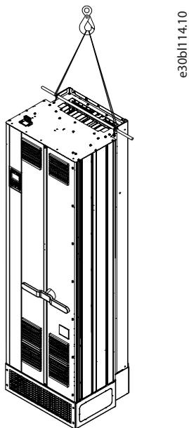
Abbildung 74: Anheben der Baugrößen Fx06–Fx10 mit Hebeösen
