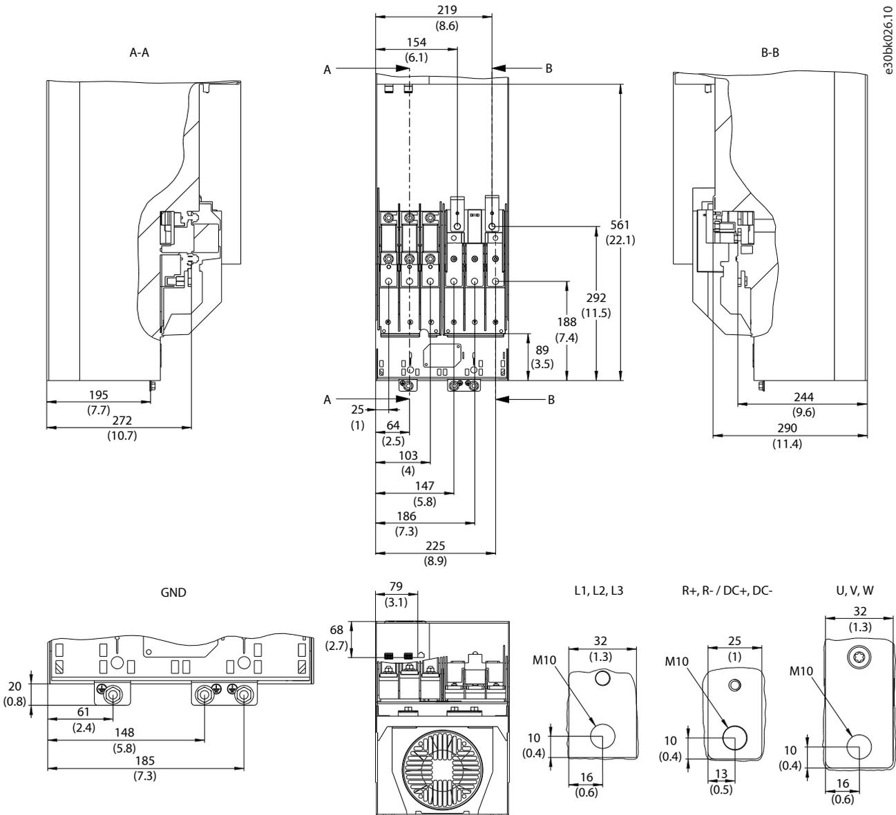
Abbildung 24: Klemmenabmessungen FA09
