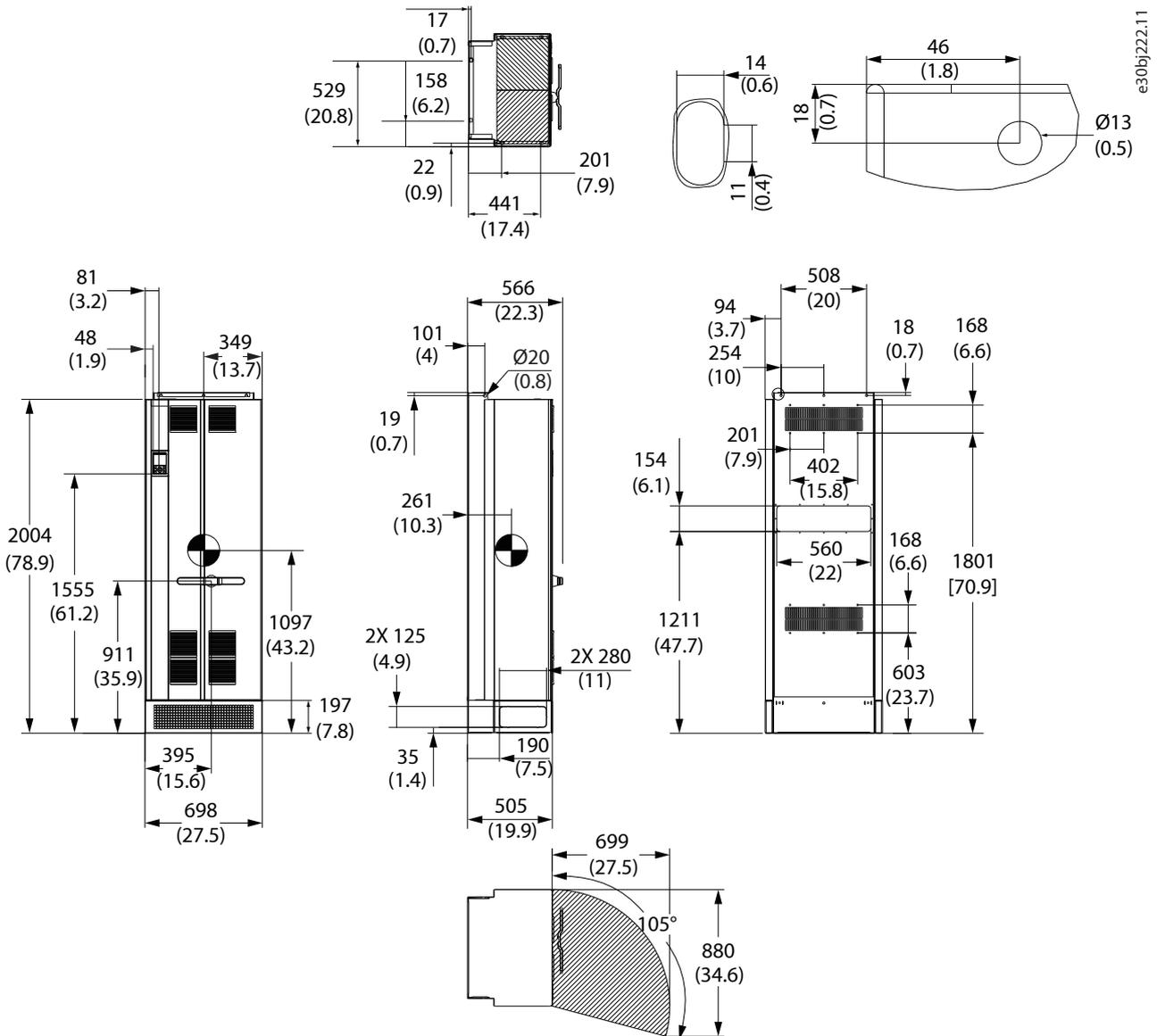
Abbildung 51: Abmessungen FB12
