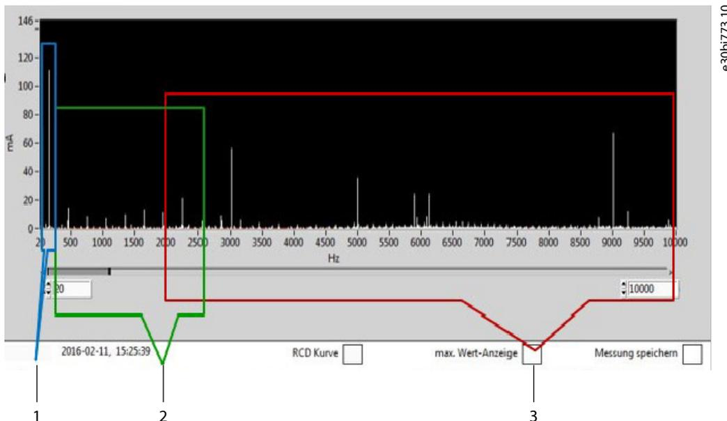
Abbildung 80: Beispiel einer FFT-Messung
