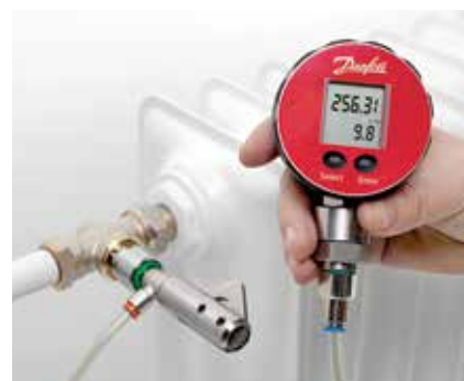
Utilizarea instrumentului Danfoss dP tool™ pentru echilibrarea unui radiator.
