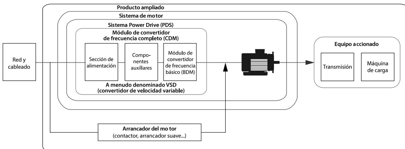
Figura 2: Diseño del accionamiento eléctrico de potencia
