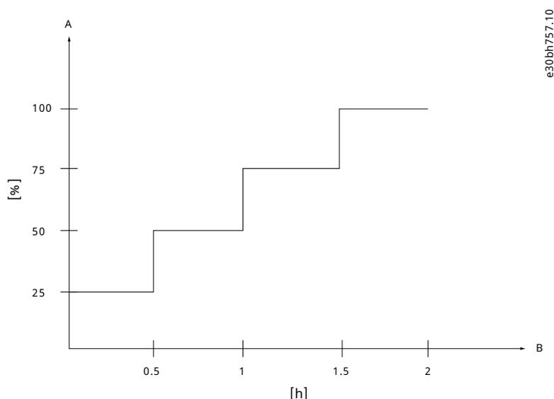
Figura 57: Procedimiento de reacondicionamiento de los condensadores de CC
