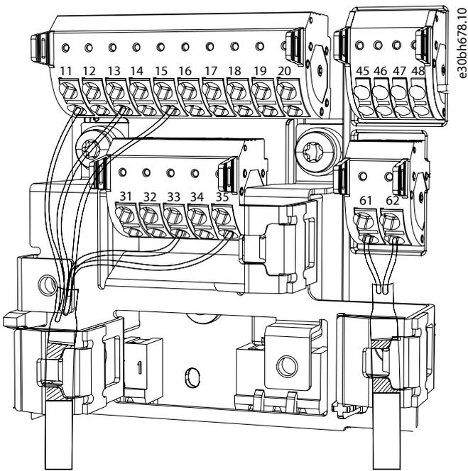
Figura 93: Conexión correcta del apantallamiento de cables
