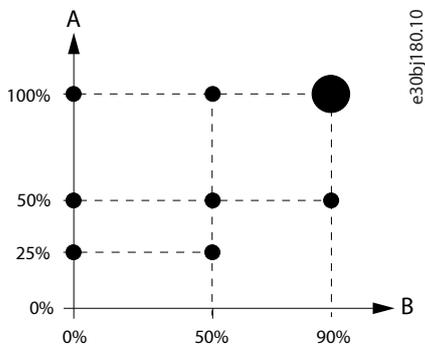
Figura 1: Punto de funcionamiento conforme a IEC 61800-9-2
