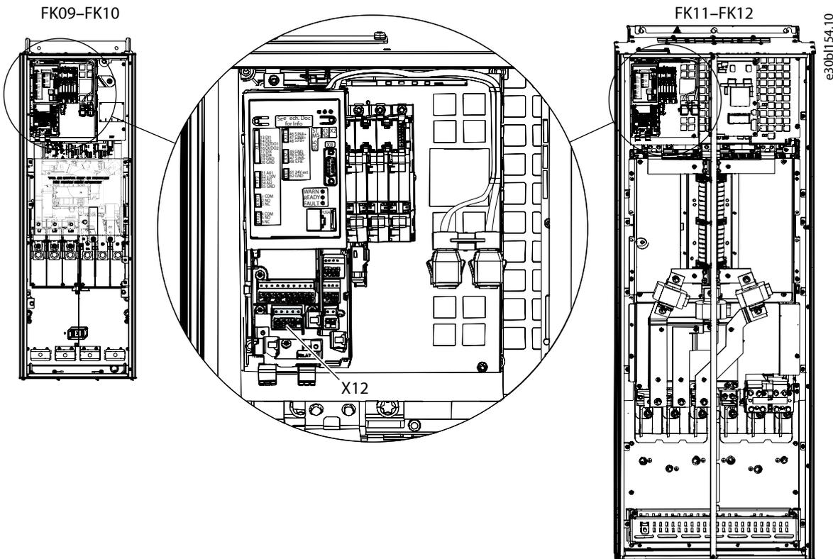
Figura 91: Conexiones de control en los bastidores FK06-FK12
