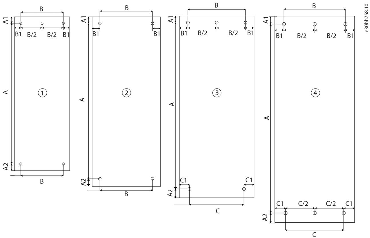
Figura 72: Patrones de perforación para bastidores FA02-FA12
