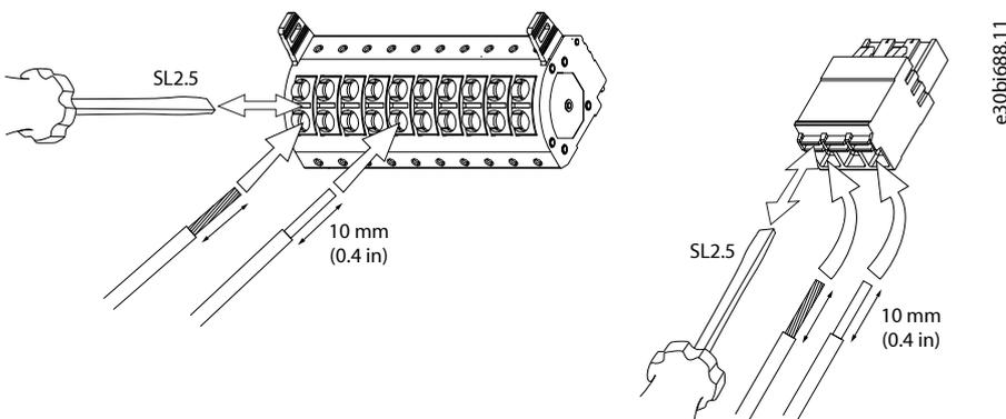
Figura 92: Inserción de cables en el conector
