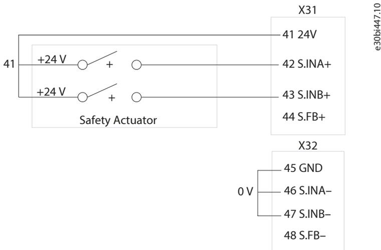
Figura 94: Ejemplo de conexión STO para utilizar las mismas polaridades (canal A y canal B = 24 V)
