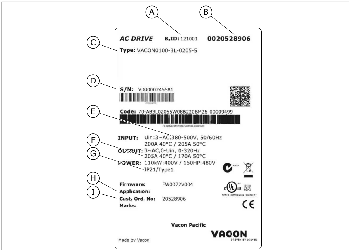
Σχ. 1: Η ετικέτα στη συσκευασία ενός ρυθμιστή στροφών AC Vacon
