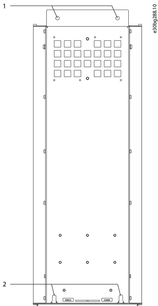
图解 11: 变频器壁装孔
