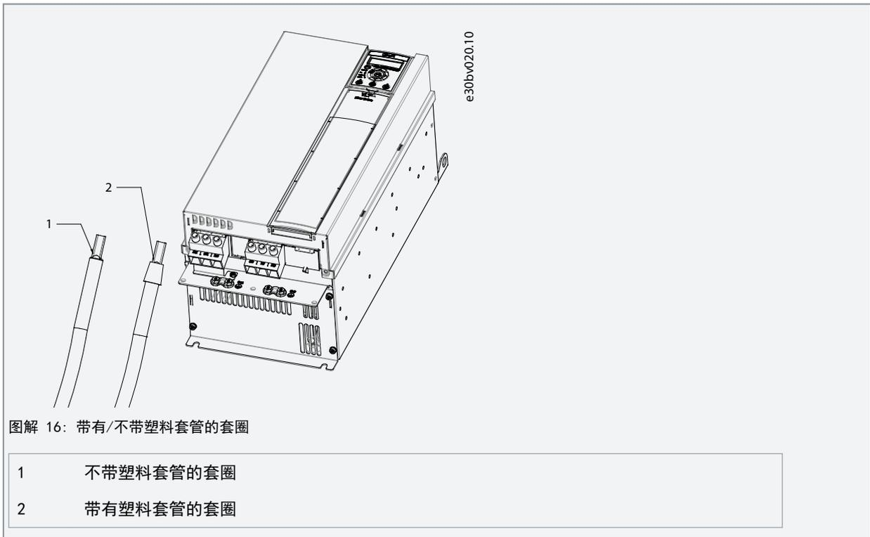
4. 将剥开的线缆装在电缆夹下以在电缆屏蔽层和大地之间形成机械固定和电气接触。
