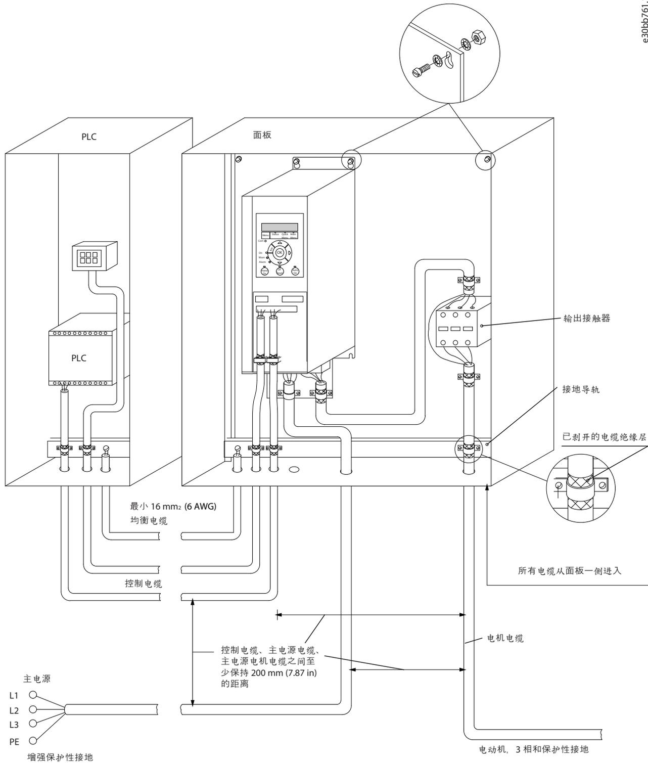
图解 13: 符合 EMC 规范的安装
