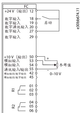
图解 22: 变频器接线
