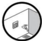
Завжди дотримуйтеся місцевих норм щодо класів IP та розміщення електрообладнання у вологих зонах. Терморегулятор не можна встановлювати в зонах прилеглих до умивальників, душових тощо (зони 0, 1 і 2). В деяких випадках, допускається розміщення терморегуляторів у ванних кімнатах - в зоні 3 або поза межами вологих зон.
