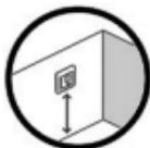
Установіть терморегулятор на стіні на зручній висоті (зазвичай 80–170 см).
