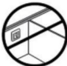
Не встановлюйте терморегулятор на внутрішньому боці зовнішньої стіни з недостатньою теплоізоляцією.
