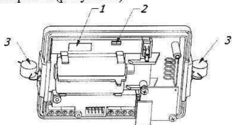
1. Место для нанесения знака поверки (в виде пломбы поверителя) на узел регулировки
