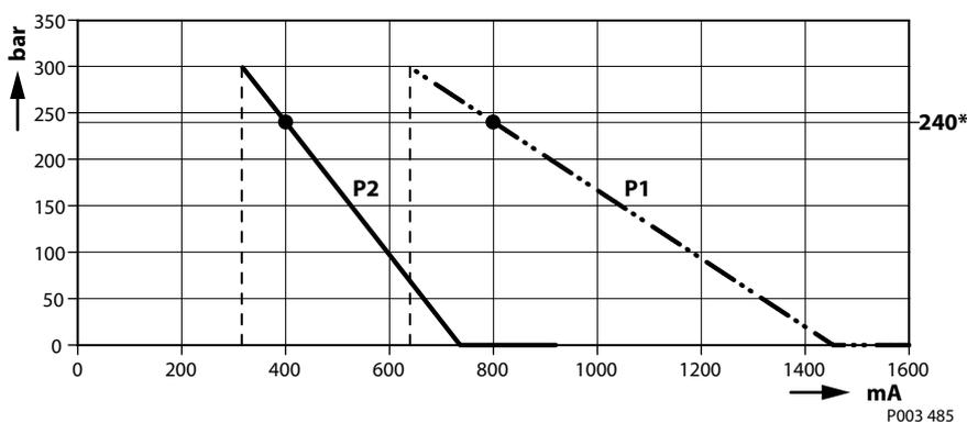
最大 PCOR 設定 = 300 bar [4351 psi], \* ラインテスト設定 = 240 bar
