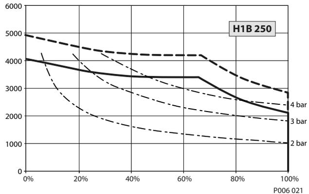
太い破線：最高速度 / 太い実線 定格速度
