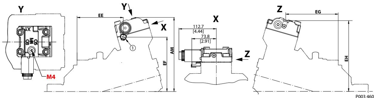
**M4** サーボゲージポート ISO 11926-1; 9/16 -18UNF-2B; Ø25.0 [0.98] 継手装着のための最大クリアランス径
