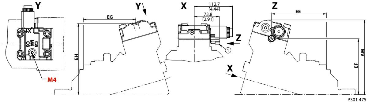
**M4** サーボゲージポート ISO 11926-1; 9/16 -18UNF-2B; Ø25.0 [0.98] 継手装着のための最大クリアランス径
