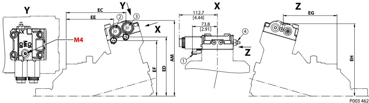
**M4** サーボゲージポート ISO 11926-1; 9/16-18UNF-2B または ISO6149 M14 x 1.5; Ø25.0 [0.98] 継手装着のための最大クリアランス径
