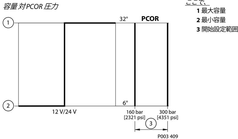
ブレーキ圧デフィート設定付 圧力補償オーバーライド
