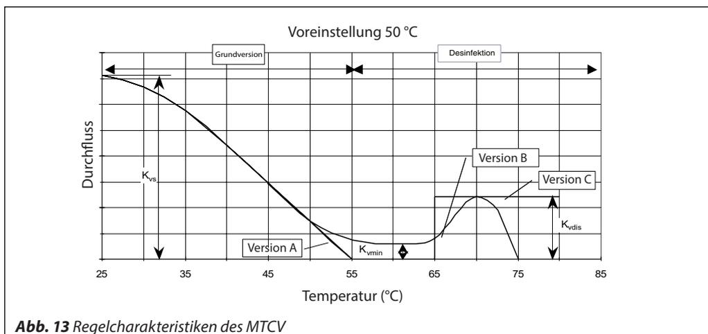
Abb. 13 Regelcharakteristiken des MTCV
