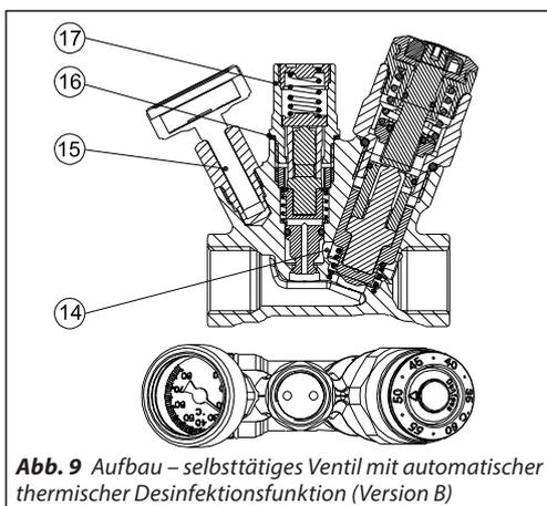
**Abb. 9** Aufbau – selbsttätiges Ventil mit automatischer thermischer Desinfektionsfunktion (Version B)
