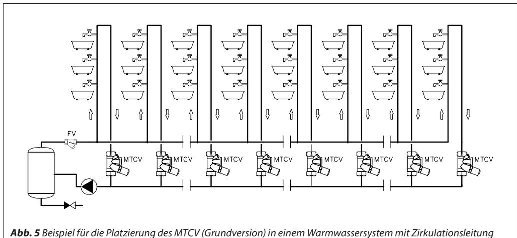
Abb. 5 Beispiel für die Platzierung des MTCV (Grundversion) in einem Warmwassersystem mit Zirkulationsleitung
