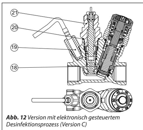
**Abb. 12** Version mit elektronisch gesteuertem Desinfektionsprozess (Version C)
