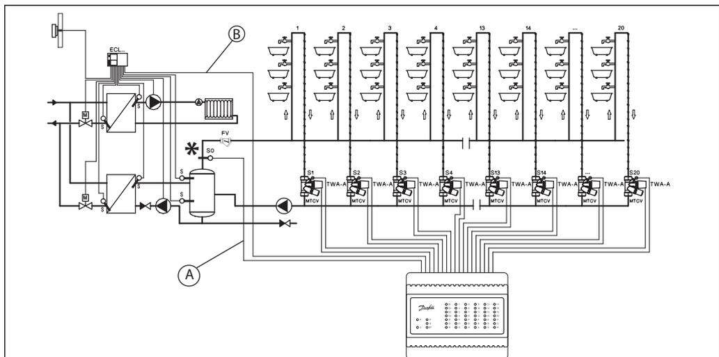
**Abb. 11** – Installationsschema für Desinfektions- und Erfassungstemperatur
