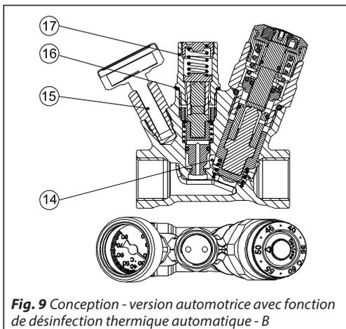
Fig. 9 Conception - version automotrice avec fonction de désinfection thermique automatique - B
