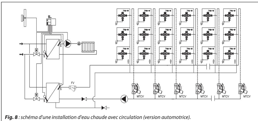
Fig. 8 : schéma d'une installation d'eau chaude avec circulation (version automotrice).
