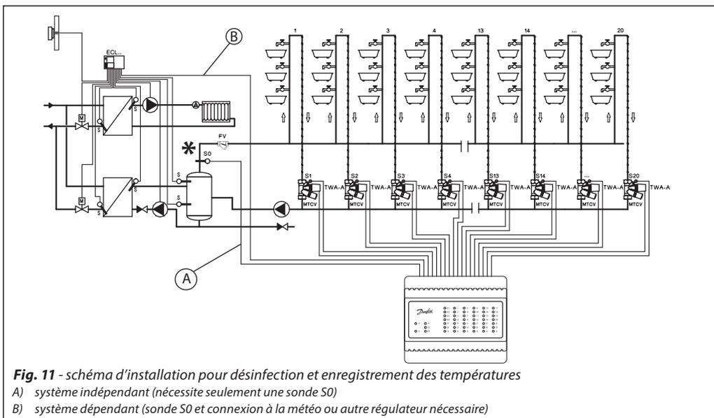
**Fig. 11** - schéma d'installation pour désinfection et enregistrement des températures
