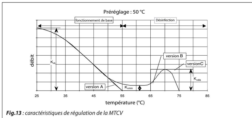
Fig.13 : caractéristiques de régulation de la MTCV
