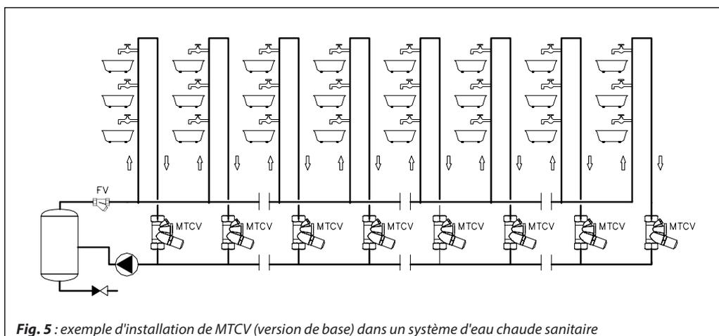
Fig. 5 : exemple d'installation de MTCV (version de base) dans un système d'eau chaude sanitaire
