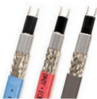
la protezione antigelo delle tubazioni. La capacità autolimitante del cavo garantisce che la potenza del cavo aumenti o diminuisca in base alla temperatura ambiente. Il cavo mantiene la sua funzionalità anche se accorciato.
