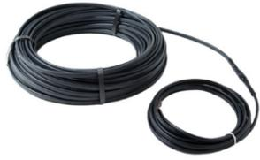
DEVlceguard™ è un cavo scaldante parallelo autolimitante utilizzato per lo scioglimento del ghiaccio e della neve su tetti, grondaie e pluviali. I cavi scaldanti DEVlceguard™ non devono entrare in contatto diretto con il bitume. La capacità autolimitante del cavo garantisce che la potenza del cavo aumenti o diminuisca in base alla temperatura ambiente.
