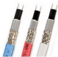
Il DEVipeguard™ LSZH è un cavo scaldante autolimitante privo di alogeni utilizzato principalmente per la protezione antigelo delle tubazioni. La capacità autolimitante del cavo garantisce che la potenza del cavo aumenti o diminuisca in base alla temperatura ambiente. Il cavo mantiene la sua funzionalità anche se accorciato. La guaina esterna è altamente resistente
