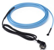
El DEVipeheat™ 10 V3 es un cable calefactor autolimitante que se utiliza para la protección contra heladas de tuberías. La capacidad autolimitante del cable garantiza que la potencia del cable aumente o disminuya en función de la temperatura ambiente. Se puede instalar un nuevo cable
