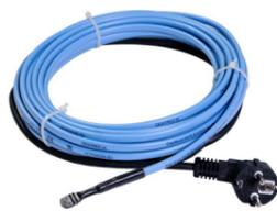
El DEVipeheat™ 10 V2 es un cable calefactor autolimitado que se utiliza para la protección contra heladas de tuberías. La capacidad autolimitante del cable garantiza que la potencia del cable aumente o disminuya en función de la temperatura ambiente. Los cables calefactores pueden instalarse en el exterior de las tuberías de agua. La
