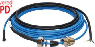
El DEVlaqua™ 9T es un cable calefactor de color azul claro, de alta calidad, redondo, resistivo en serie, totalmente blindado, con doble conductor, una funda exterior resistente y un accesorio especial para tuberías de 3/4" y 1". Está homologado para su uso en contacto con agua potable hasta 23 °C.
