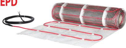
La manta calefactora lista para usar DEVIflex™ es un cable de doble conductor de 360° de muy alta calidad, totalmente blindado con una funda exterior resistente (no resistente a los rayos UV) fijada a la malla de plástico. Su perfil redondo y su construcción robusta garantizan una instala-
