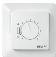
utilizado para controlar sistemas de calefacción por suelo radiante Comfort. El termostato tiene un dial para ajustar la temperatura con una escala numérica de \* a 6 (es decir, de 5 °C a 45 °C, y cada paso corresponde a aproximadamente 8 °C).
