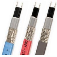
tuberías. La capacidad autolimitante del cable garantiza que la potencia del cable aumente o disminuya en función de la temperatura ambiente. El cable mantendrá su funcionalidad incluso si se acorta. La cubierta exterior es muy resistente a las condiciones ambientales adversas y a la corrosión, y también sirve como protección contra las influencias mecánicas. Todos los cables calefactores autolimitantes deben estar protegidos
