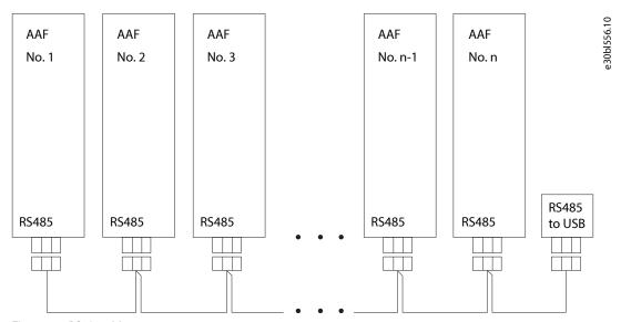
Figure 41: RS485 wiring
