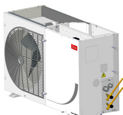
Krok 3: Odkręcić wszystkie śruby panelu bocznego.
