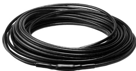
DEVI<sup>TM</sup> 30 ist ein extrem hochwertiges Zweileiterheizkabel. Es verfügt über eine 360°-Abschirmung. Die besonders robuste Außenisolierung ist UV-beständig. Ihr Rundprofil und die robuste Konstruktionsweise ermöglichen eine schnelle, unkomplizierte und sichere Installation. Typische Anwendungen sind Dach-, Dachrinnen- und Fallrohrheizung sowie Freiflächenheizung. Der Kaltleiter verfügt über massive Leiter, was die Klemm-
