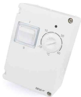
DEVIreg™ 610 ist ein elektronischer Thermostat, der sich zur Temperaturregelung von vielen Anwendungen im Innen- und Außenbereich eignet. Zum Beispiel Rohrbe- gleitheizungen, Fußbodenheizungen und Frühbeetheizungen. Er ist mit einem zwei- poligen Schalter und einem Leitungsfühler ausgestattet.
