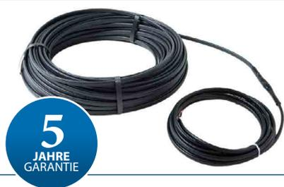
DEVlceguard™ ist ein selbstlimitierendes Heizband, das zur Eis- und Schneefreihaltung von Dächern, Ablaufrinnen und Fallrohren eingesetzt wird. DEVlceguard™-Heizkabel sollten nicht in direktem Kontakt mit Bitumen stehen. Durch die Selbstlimitierung des
