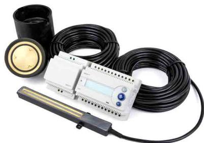
DEVIreg™ 850 ist ein hochmoderner Thermostat mit beleuchteter LCD-Anzeige. Geeignet zur Steuerung von Freiflächen- und Dachrinnenheizungen. Die Fühler liefern permanent Daten über den Feuchtigkeitsgrad und die Temperatur. Mit diesen Parametern wird sichergestellt, dass die Anlage nur in Betrieb geht, wenn Eisbildung oder Glättegefahr droht.
