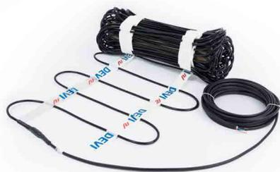
DEVIsnow™ ist eine extrem hochqualitative Zweileiterheizmatte. Das Zweileiterheizkabel verfügt über eine 360°-Abschirmung. Die besonders robuste Außenisolierung ist UV-beständig. Ihr Rundprofil und die robuste Konstruktionsweise ermöglichen eine schnelle, unkomplizierte und sichere Installation. Typische Anwendungen sind Freiflächenheizungen in Beton oder Mörtelbett sowie in Sand unter Pflastersteinen verlegt.
