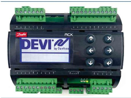
DEVIreg™ Hotwater ist ein elektronischer, programmierbarer Regler mit 4 Kanälen für die Montage auf DIN Schienen. Jeder Kanal kann individuell eingestellt werden, um heißes Wasser manuell oder nach einem Zeitplan zu desinfizieren. Die Sensoren der Kanäle können aus 7 verschiedenen Temperatursensoren ausgewählt werden einschließlich NTC 15 kOhm bei 25°C. Die Steuerung des Gebäudemanagementsystems (BMS) ist über die serielle Schnittstelle Modbus RS485 möglich.
