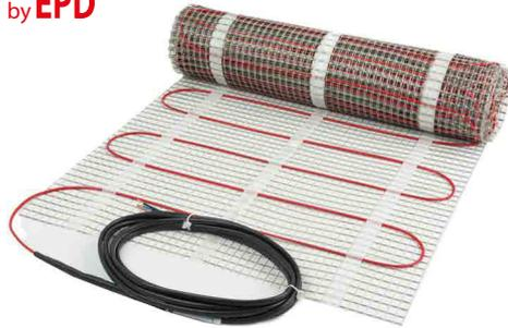
DEVImat™ ist eine extrem hochqualitative Heizmatte zur Verlegung in Fliesenkleber oder Ausgleichsmasse. Die Zweileiterheizleitung verfügt über eine 360°-Abschirmung und eine robuste rote PVDF-Außenisolierung. Die robuste Konstruktionsweise und die geringe Aufbauhöhe von 3,5 mm ermöglichen eine schnelle, unkomplizierte und sichere Installation, speziell auch bei der Renovierung bestehender Fußböden.
