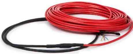
DEVIflex™ ist ein 360° abgeschirmtes Zweileiterheizkabel von besonders hoher Qualität mit einer widerstandsfähigen Außenhülle (nicht UV-beständig). Das Rundprofil und die robuste Konstruktionsweise ermöglichen eine schnelle, unkomplizierte und sichere Installation als Fußbodenheizung im Innenbereich sowie als Rohrbegleitheizung. Der Kaltleiter mit den massiven Leitern vereinfacht die Klemmarbeiten. Die deutlich erkennbare Übergangsmuffe von der Heizleitung auf den Kaltleiter vermeidet eine
