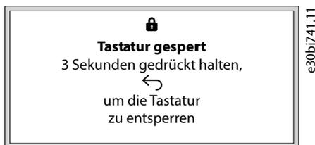
Abbildung 12: Sperrbildschirm der Bedieneinheit
