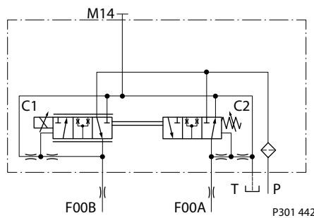
H1 系列 FDC 控制泵 **PL** 阀出厂设定值为 150 bar [2175 psi]。为确保风扇达到所需转速, 以满足系统的冷却需求, 必须对 **PL** 重新调整。HPRV 设定值必须始终比 **PL** 设定值至少高 30 bar [435 psi]。
