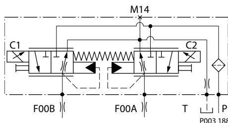
泵排量与电磁阀信号电流成正比, 但是这也随着泵输入速度和系统压力的变化而改变。系统压力升高, 泵排量减小的特性使得泵具备功率限制功能。一种典型的响应特性如图所示。在某些情况下, 例如: 油液受到污染时, 控制阀芯有可能被卡住, 会导致泵保持在某一排量下而不能正常的变量。
