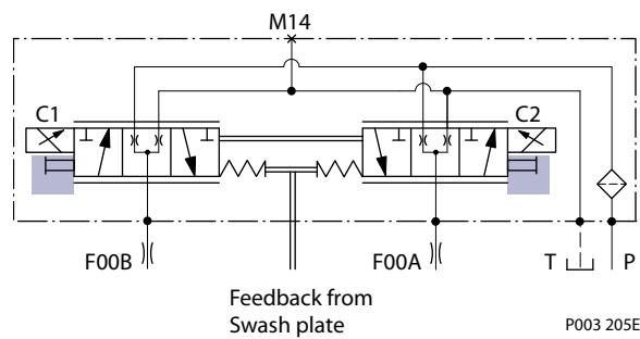
触发手动越权功能时泵会有流量输出。在使用 MOR 功能时, 车辆或设备必须始终处于安全状态 (如: 将车辆支离地面)。
