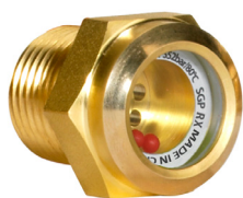
Figura 5: Os visores ajudam a determinar a qualidade do refrigerante e geralmente incluem um indicador de umidade. As válvulas de esfera são usadas para isolar o refrigerante antes da manutenção.
