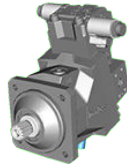
Elektromagnet C6 Stromlos = min. Schluckvolumen Voll bestromt = max. Schluckvolumen
