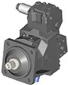
电磁阀线圈 C6 失电 = 最小排量 得电 = 最大排量
