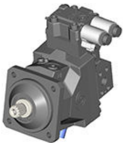
电磁阀线圈 C6 失电 = 最小排量 完全得电 = 最大排量
