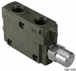
EHPS 转向阀内置有优先阀，但是用于最大泵流量 120 l/min [31.7 USgal/min]。在配备 EHPS 且泵流速介于 120 l/min [31.7 USgal/min] 和 320 l/min [84.5 USgal/min] 之间的系统中，EHPS 和 OLS 320 组合提供良好的紧凑式解决方案，与独立元件相比，可以降低壳体和安装成本。有关该 OLS 320 的更多详情：查看 EHPS 样本 520L0521。
