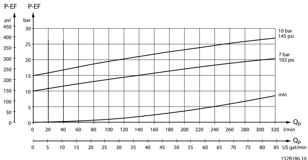
OLS 160 和 OLS 320, 先导压力溢流阀 (P - T, Q<sub>p</sub>) 特性
