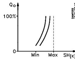
Permet la régulation selon la charge de l'évaporateur au moyen d'une recherche MSS (MSS = surchauffe minimum admissible).
