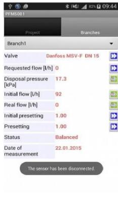
2. Der gemessene Durchflusswert wird unter dem Parameter „Durchfluss tatsächlich“ des ausgewählten Strangs angezeigt.
