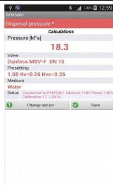
6. Die Voreinstellung für den gewünschten Durchfluss wird unter „Ergebnis“ angezeigt. Falls sich der gewünschte Durchfluss nicht erzielen lässt, wird eine Meldung eingeblendet, dass die Voreinstellung außerhalb des möglichen Bereichs liegt.
