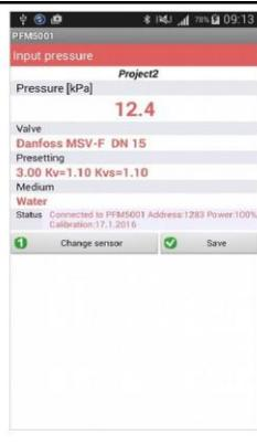
4. Schließen Sie die Messeinheit des PFM 5001 an das Ausgleichsventil in einem beliebigen Strang an und wählen Sie den entsprechenden Strang in dem Register „Stränge“ aus. Es ist erforderlich, sowohl den Durchfluss des Ventils bei der eingestellten Voreinstellung als auch den verfügbaren Druck im Strang bei geschlossenem Ausgleichsventil zu messen. Der gemessene Wert wird automatisch in das entsprechende Feld übernommen.
