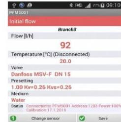
9. Fügen Sie die übrigen in dem Projekt enthaltenen Stränge gemäß den oben genannten Anweisungen hinzu. Beachten Sie, dass die Reihenfolge der Stränge in dem Projekt dem Abstand der einzelnen Stränge zur Eingangsdruckquelle entsprechen muss.
