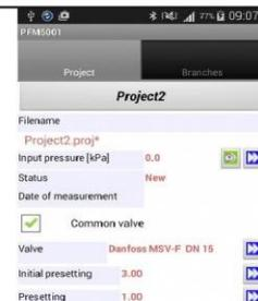
5. Sie können den Eingangsdruck über das Symbol „Messung“ in der entsprechenden Zeile messen. Die berechnete Voreinstellung für das Hauptventil wird am Ende des Projektabgleichs im Fenster „Voreinstellung“ angezeigt.
