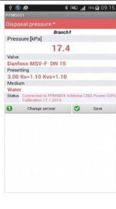
6. Messen des Anfangsdurchflusses im Strang. Das PFM 5001 wählt automatisch das korrekte Ventil und die richtige Voreinstellung gemäß dem ausgewählten Strang. Der gemessene Anfangsdurchfluss wird zusammen mit den restlichen Strangdaten gespeichert.
