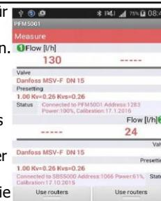
2. Diese dürfen nicht das Signal verlieren. Wenn die Router platziert sind, müssen Sie die linke Taste „Router verwenden“ betätigen.
