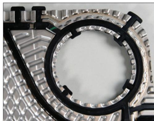
Fig. 4. Junta Hang-On
