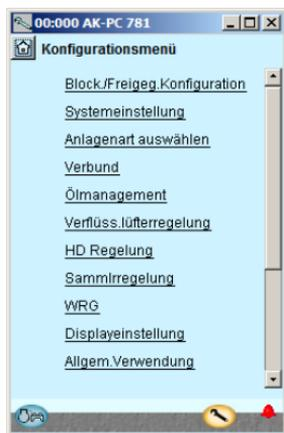
Die Anzahl der Menüpunkte passt sich der Konfiguration an, sodass nur relevante Menüs sichtbar sind.
