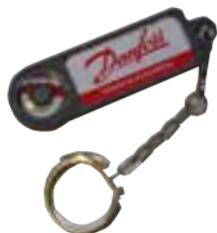
Dieses praktische Werkzeug für den Schlüsselring reagiert auf die Magnetfelder von Magnetventilen. Wenn Sie den Magnetfeldanzeiger in der Nähe der Spule positionieren, dreht sich die rot-weiße Scheibe – sofern die Spule aktiv ist.
