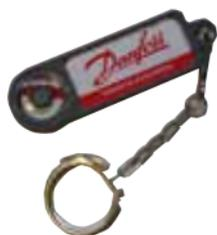
Esta herramienta portátil tipo llavero reacciona a campos magnéticos de las válvulas solenoides. Coloque el indicador cerca de la bobina y el disco rojo y blanco girará si la bobina está activa.
