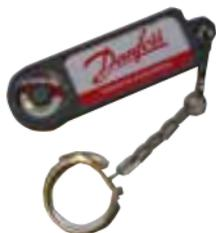
Этот удобный инструмент с кольцом для ключей реагирует на магнитные поля, создаваемые электромагнитными клапанами. Поднесите индикатор к катушке, и по вращению красно-белого диска определите, активна ли катушка.
