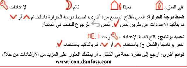
ضبط درجة الحرارة: المس مقاوح الوضع ذي الصلة، اضطرد درجة الحرارة باستخدام أو . قم بتاكيد الإعدادات عن طريق المس للرجوع للخلف في القائمة.
