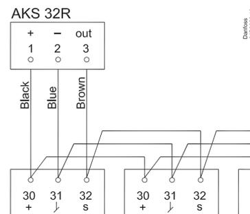
Le signal provenant d'un transmetteur de pression peut être reçu par jusqu'à dix régulateurs. Une chute de pression importante ne peut pas se produire entre la position du transmetteur de pression de la conduite d'aspiration et la température S2 des évaporateurs.
