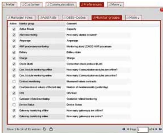
Abbildung 18.6: Konfiguration von Überwachungsgruppen
