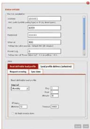
Abbildung 5.4: Konfiguration des Kommunikationsmoduls: Geräteparameter
