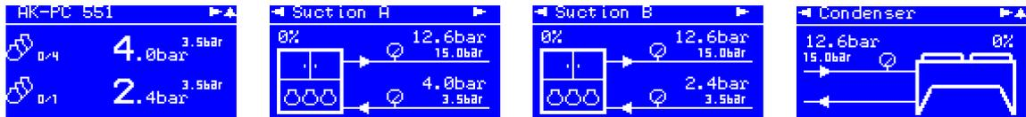
Для каждого из приведенных выше четырех рядов имеется три дополнительных дисплея. Стрелка в верхнем углу дисплея указывает путь к следующему дисплею для той же области эксплуатации. Если нажать правую стрелку, появятся следующие три дисплея:
