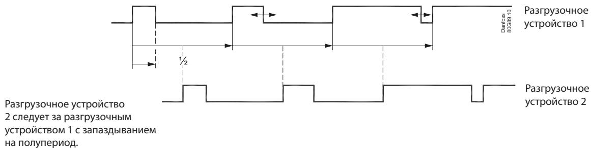
CRII 6: Импульсный сигнал также может использоваться для управления одним компрессором CRII с тремя разгрузочными клапанами (версия с 6 цилиндрами).
