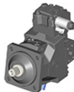
ソレノイド C6 非励磁 = 最大容量 励磁 = 最小容量
