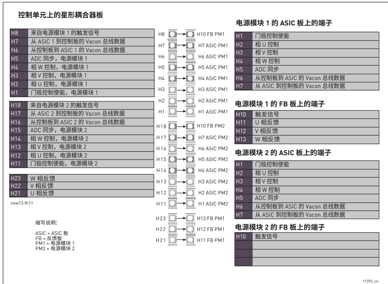
图 77. 星形耦合器板、ASIC 板和反馈板 (CH64 和 CH74) 之间的端子和连接
