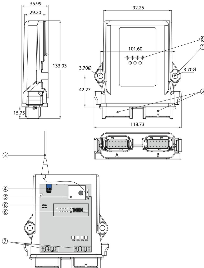
1. Ranuras para la fijación (montaje fijo o anti vibración)
