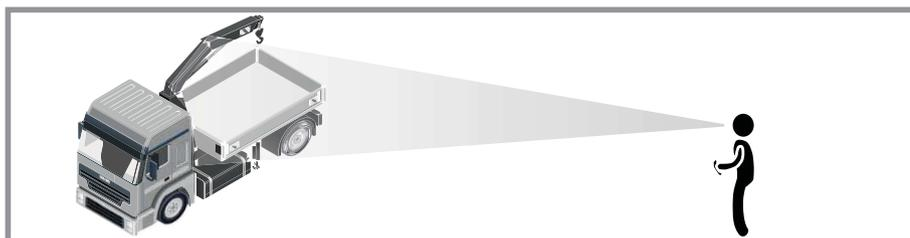
2. Opcional: En el caso de que se dificulte la visión directa de la antena del receptor con respecto a la zona de trabajo del emisor, se recomienda utilizar antenas externas y posicionar dicha antena externa en zonas despejadas utilizando prolongadores de antena (en los modelos que permitan dicha antena).
