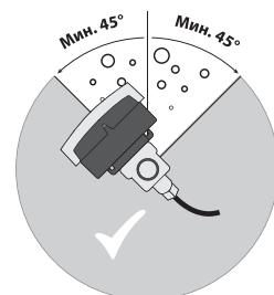
Положение относительно трубы: расходомер должен быть расположен под углом от 45 до 315° во избежание скопления воздуха
