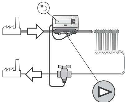
Установка на подающем трубопроводе
