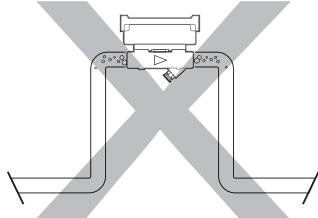
Местоположение на трубопроводе: без ограничений, но следует избегать мест, в которых может скапливаться воздух
