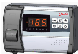
Fig. 8. Cierre el panel frontal, prestando atención a que todos los cables estén dentro de la carcasa y a que la junta de esta quede encajada correctamente. Apriete el panel frontal con los 4 tornillos. Aplique tensión al panel y efectúe la consulta y programación exhaustivas de todos los parámetros.
