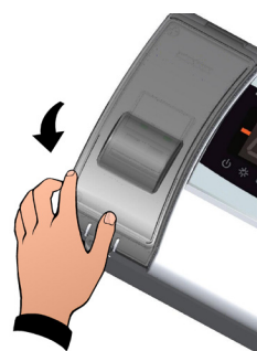
Fig. 3. Cierre la protección transparente del disyuntor magnetotérmico.
