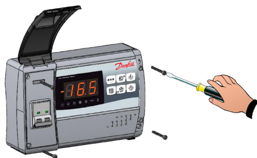
Fig. 2. Desatornille los 4 tornillos de fijación del frontal de la carcasa..
