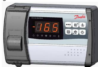
Abb. 8 Schließen Sie die Frontblende, nachdem Sie sichergestellt haben, dass sich alle Kabel im Inneren des Gehäuses befinden und dass die Gehäusedichtung sicher in ihrem Sitz liegt. Die Frontblende mit den vier Schrauben befestigen. Schalten Sie den Strom am Bedientableau ein und importieren/konfigurieren Sie alle Parameter.
