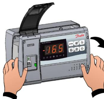
Abb. 4 Öffnen Sie die Vorderseite des Gehäuses, heben Sie es an und schieben Sie die beiden Scharniere ganz heraus.
