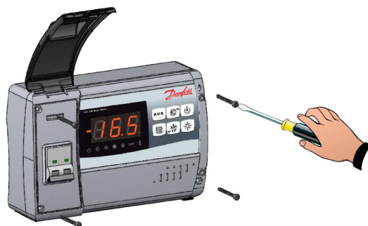
Rys. 2 Odkręć 4 wkręty mocujące znajdujące się w przedniej części skrzynki.
