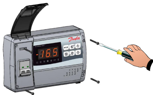
Fig. 2. Verwijder de 4 bevestigingsschroeven aan de voorzijde van de kast.
