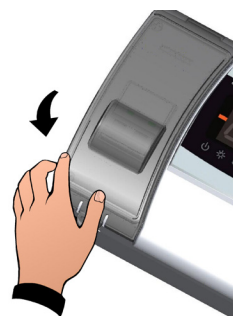
Fig. 3. Sluit de transparante beschermingskap van de magnetothermische stroomonderbreker.
